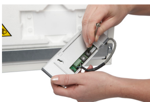
Indregulering af kontrolpanelet
